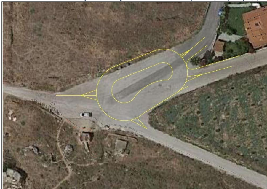
Εικόνα Error! No text of specified style in document. -5: Προτεινόμενη Διαμόρφωση Κόμβου Καποδίστρια - Κρήνης
